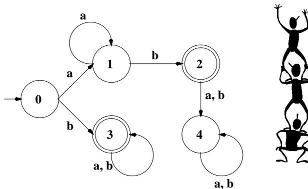
. Automate reconnaissant  $(c_1.c_2 \dots c_p)^n, n \geq 0, c_i \in \Sigma$
